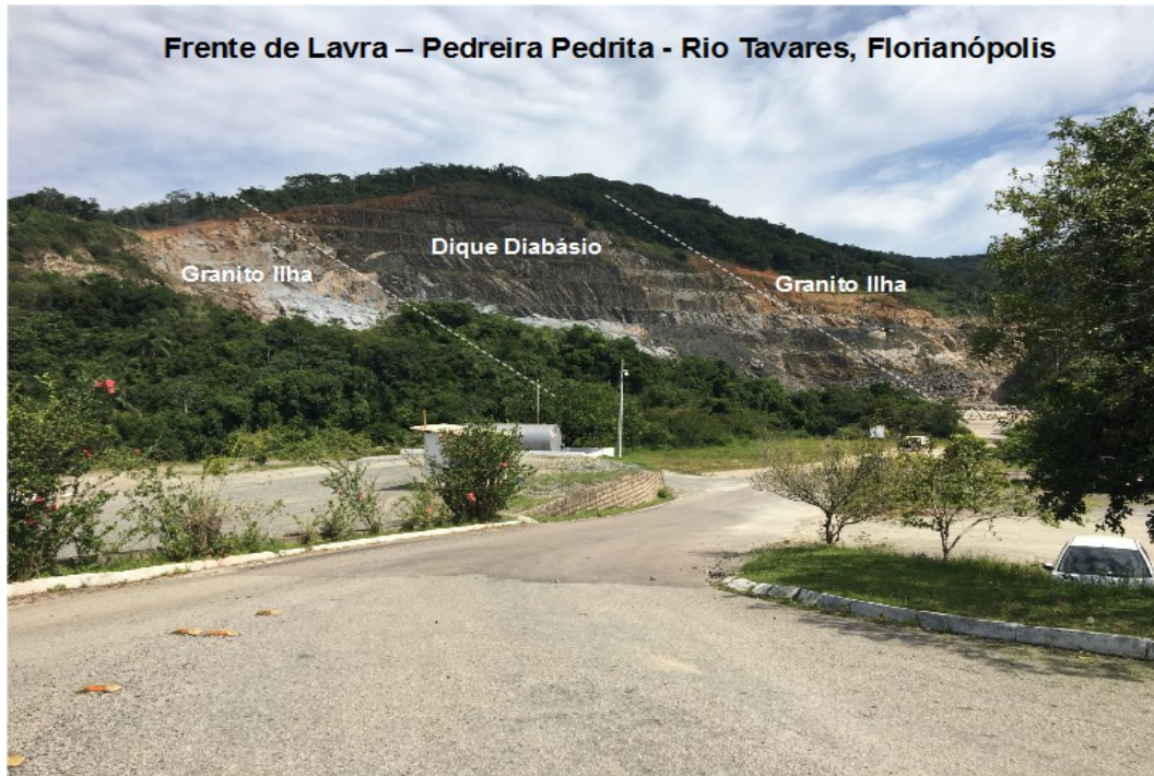
Figura 5.2 - Frente de lavra da Pedreira Pedrita – Rio Tavares, Florianópolis, caracterizada pelo Granito Ilha (granito grosseiro, cinza claro), que é cortado por dique de diabásio (Formação Serra Geral), de cor cinza escura
